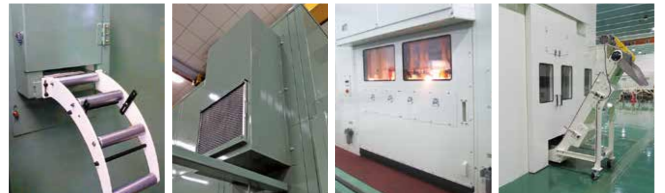
材料入側開口ダクト 換気ダクト(フィルター付) 自動昇降シャッター スクラップコンベア開口
