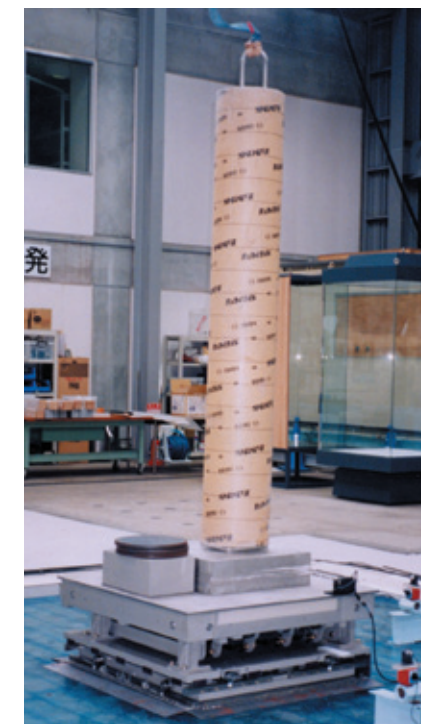
プリンス頓美術館三次元免震装置 実証試験風景
